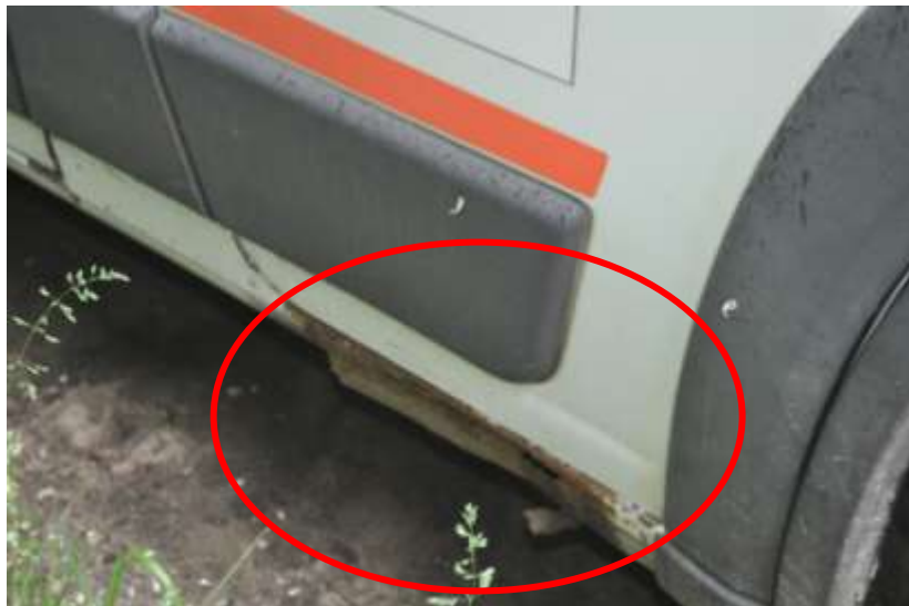
Fot. nr 9. Badania pojazdu – zakres uszkodzeń.
