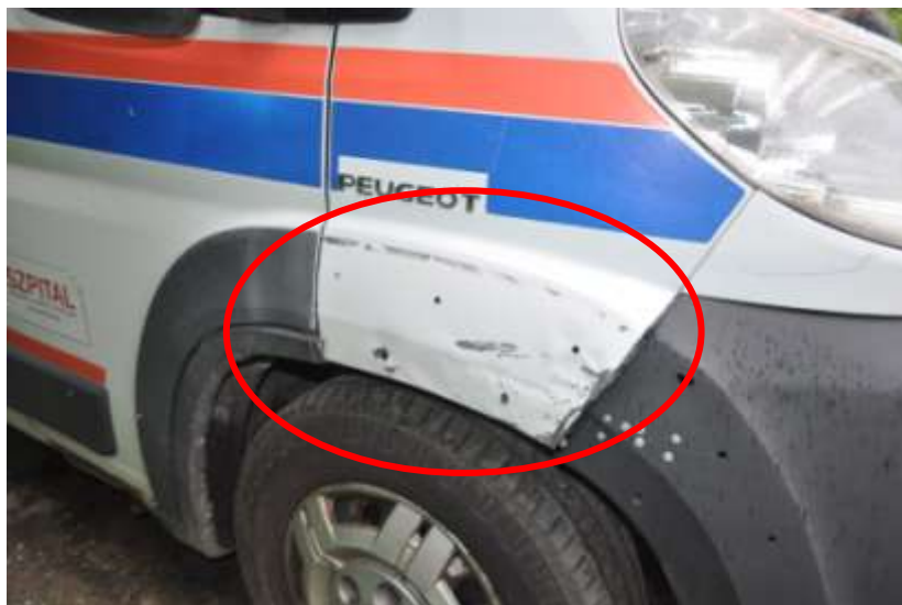
Fot. nr 8. Badania pojazdu – zakres uszkodzeń.
